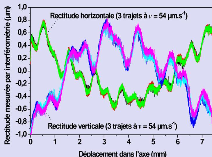
Capteur optique 1 axe (LISV)
