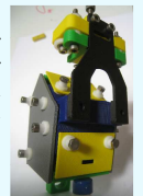
Modèle taille réelle du secteur électrostatique réalisé à l'aide d'une imprimante 3D
